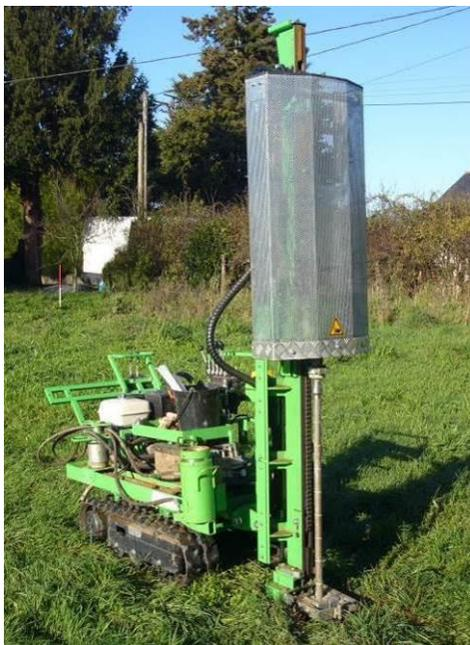
**Foreuse équipée d'un pénétromètre dynamique type B**
